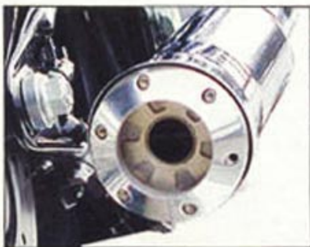
En position fermée, l'échappement Kess-Tech ne fait pas plus de bruit que celui d'une Harley de série.
